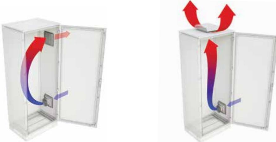
Вентиляционное оборудование, входящее в систему "RAM klima", является самым простым и бюджетным решением для организации охлаждения компонентов, расположенных внутри шкафа. При выборе данного типа охлаждения, необходимо соблюдать главное условие – температура окружающей среды  $T_a$  должна быть ниже, чем температура внутри шкафа  $T_i$ , при этом  $T_i - T_a \geq 5 \text{ }^\circ\text{C}$ .
