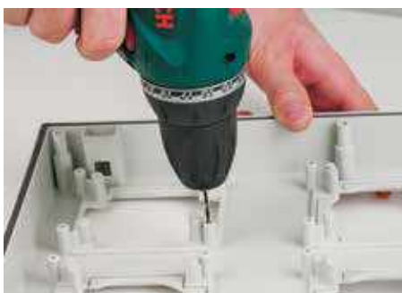
Розетка встановлюється на нові посадкові місця. Заблоковані за замовчуванням отвори для зручності встановлення необхідно наскрізь просвердлити (діаметр свердла - 3 мм) Отвір непотрібний для розетки з фланцем 70x87 мм (DIS5706407 та ін.) The socket is installed on new slots. The holes blocked by default should be drilled through for ease of installation (drill diameter is 3 mm) The hole is unnecessary for a socket with a 70x87 mm collar (DIS5706407, etc.) The socket is installed on new slots. The holes blocked by default should be drilled through for ease of installation (drill diameter is 3 mm) The hole is unnecessary for a socket with a 70x87 mm collar (DIS5706407, etc.)
