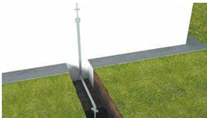
Заземлення струмоспуску Grounding the current release
