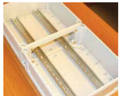
6. Стяните болтами, установите DIN-рейки
