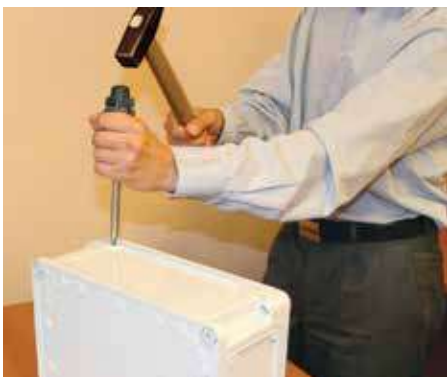
1. Удалите соединительные отверстия
