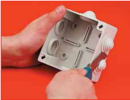
1 этап. Срезаем кабельный ввод
