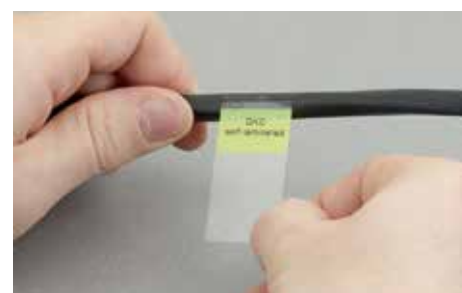
Закрепить маркировочный элемент на поверхности
