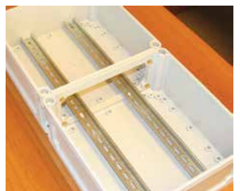
6. Стяните болтами, установите DIN-рейки
