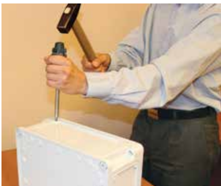
1. Удалите соединительные отверстия
